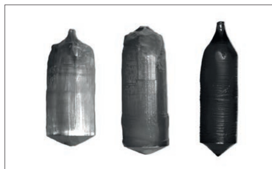
Na okładce: Monokryształy (od lewej) \text{ScAlMgO}_4 , \text{ScAlMgO}_4\text{:Co} , \text{MgAl}_2\text{O}_4\text{:Co} .
