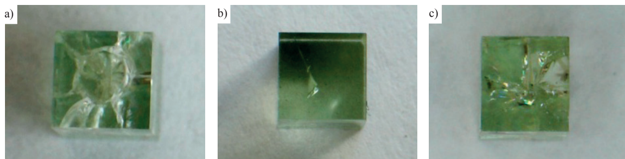
Rys. 6. Przykłady uszkodzeń próbek szkła ELG w eksperymentach generacyjnych.
